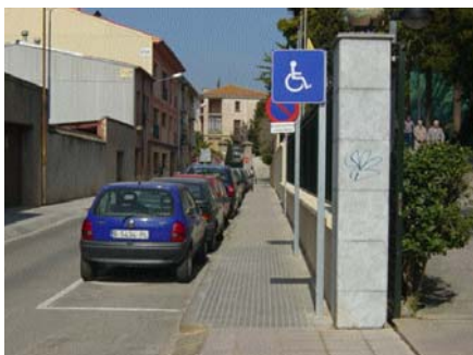
Ejemplo de plazas de aparcamiento reservado con señalización vertical y horizontal
