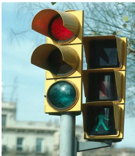
Ejemplo de semáforo con módulo acústico y señalización visual
