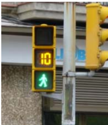
Ejemplo de semáforo con módulo acústico y señalización visual
